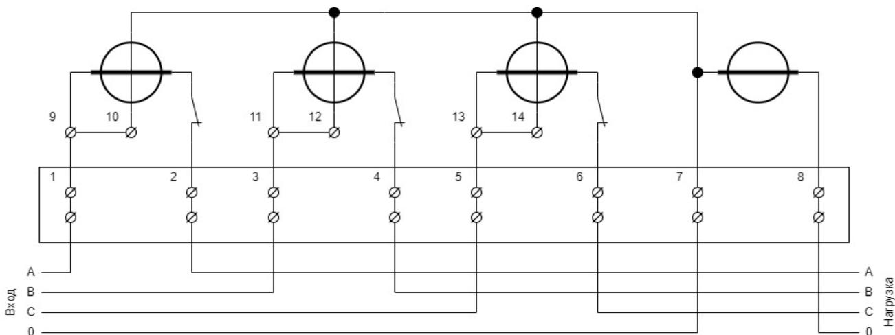
Рисунок Б.1 - Схема четырехпроводного непосредственного подключения счетчика.
