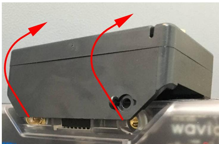
Рисунок 6.2 – Снятие модуля связи.
