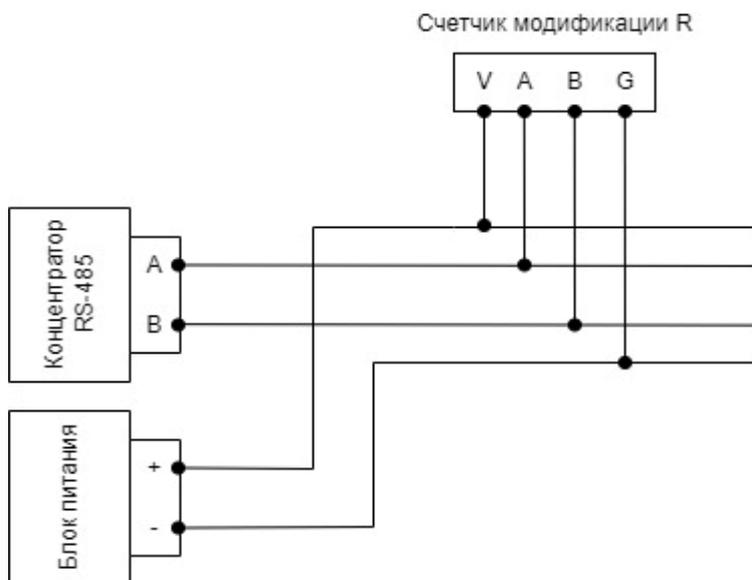
Рисунок 6.7 – схема подключения интерфейса RS-485 счетчиков модификации R
