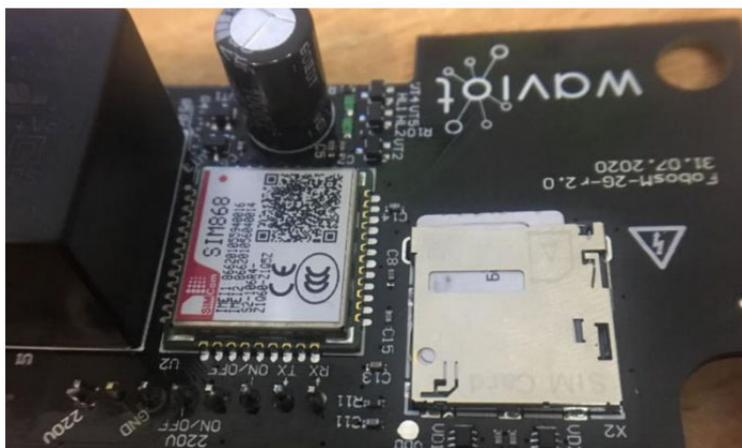
Рисунок 6.5 – Плата сменного модуля связи 2G.
