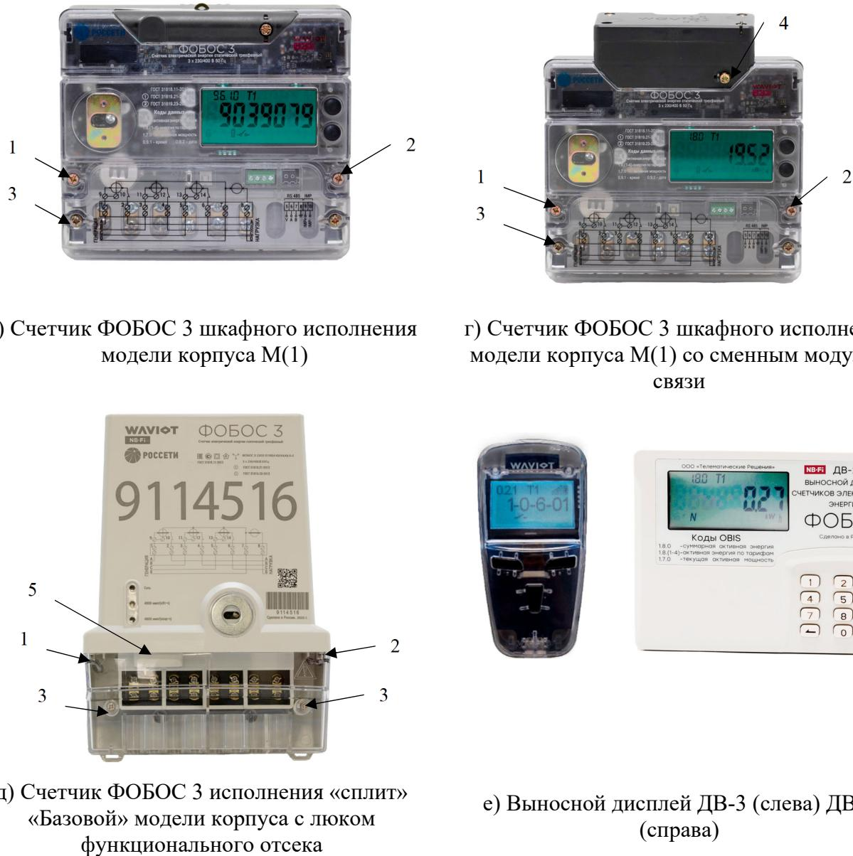
Рисунок 3.1 - Общий вид и схемы пломбировки счетчиков.
