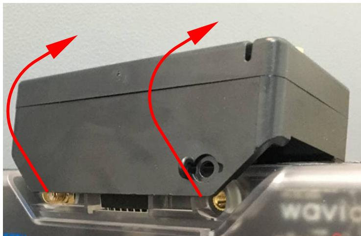
Рисунок 6.2 – Снятие модуля связи.
