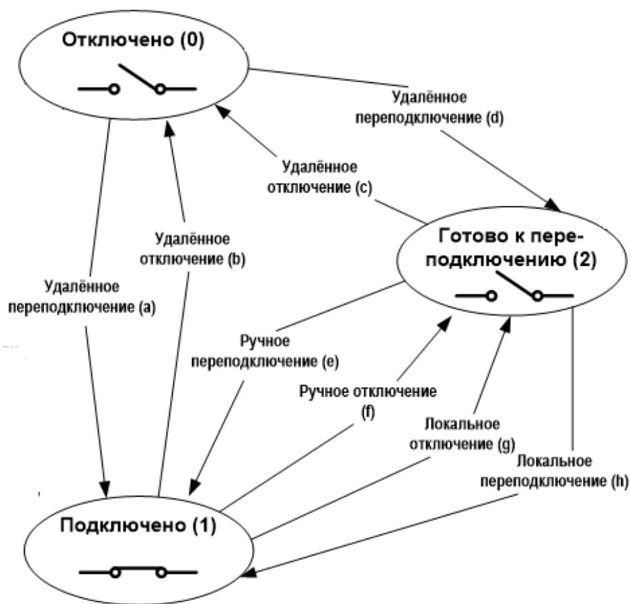
Рисунок 5.1 – Схема переходов состояний реле нагрузки.
