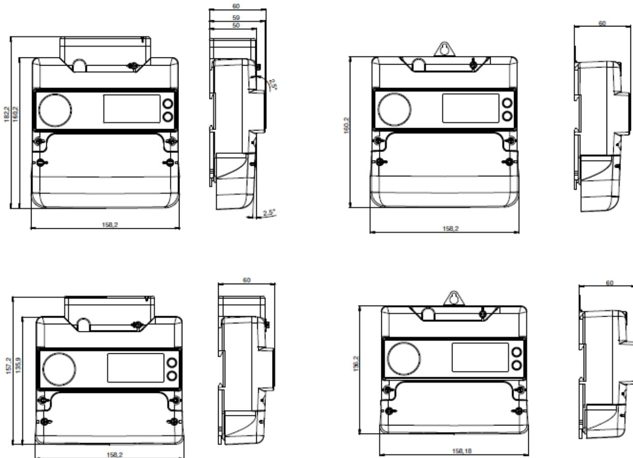
Рисунок А.2 - Габаритные и установочные размеры счетчиков шкафного исполнения 1 модели
