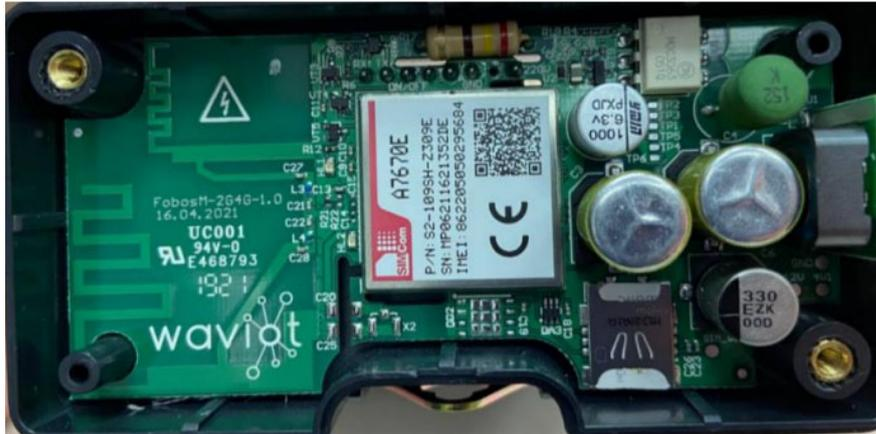
Рисунок 6.6 – Плата сменного модуля связи 2G/4G
