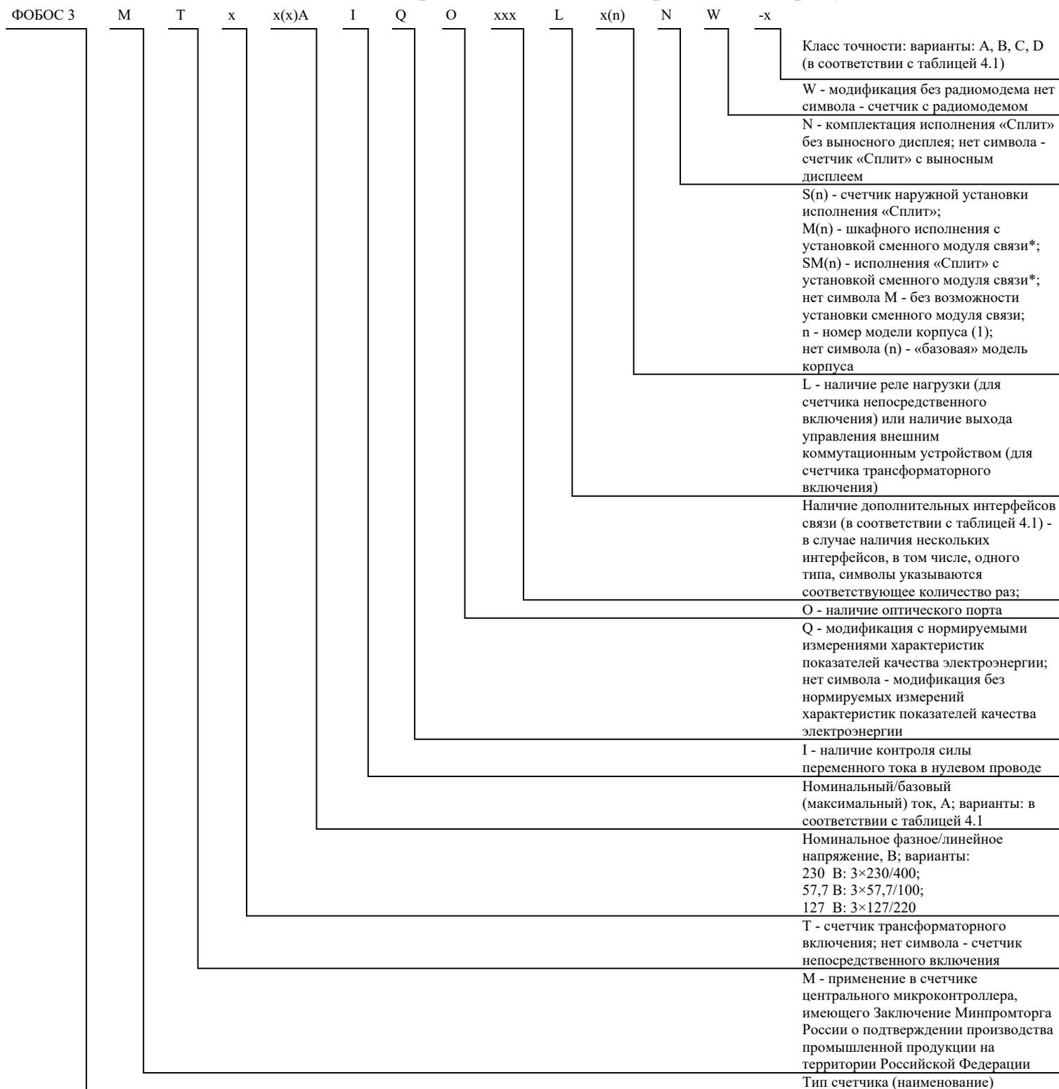
Рисунок 3.2 - Структура обозначения возможных модификаций счетчиков
